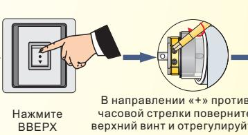
В направлении «+» против часовой стрелки поверните верхний винт и отрегулируйте штору до нужного положения
