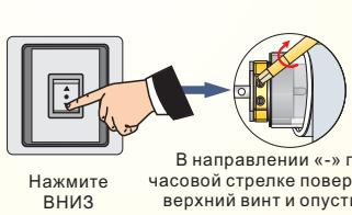
В направлении «-» по часовой стрелке поверните верхний винт и опустите штору до нужного положения
