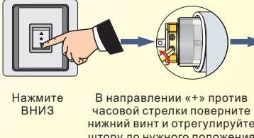
В направлении «+» против часовой стрелки поверните нижний винт и отрегулируйте штору до нужного положения
