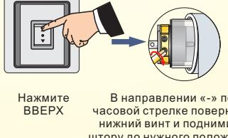
В направлении «-» по часовой стрелке поверните нижний винт и поднимите штору до нужного положения
